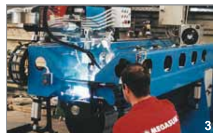
Ρομπότ οριζόντιας συγκόλλησης των δεξαμενών.
