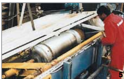
Συγκρότημα δοκιμής πίεσης των δεξαμενών.
