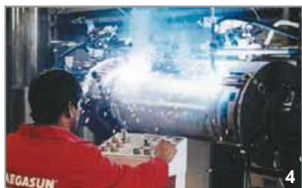
Ρομπότ περιμετρικής συγκόλλησης των δεξαμενών.
