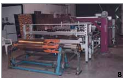
Αυτόματο συγκρότημα διαμόρφωσης και συγκόλλησης απορροφητών.
